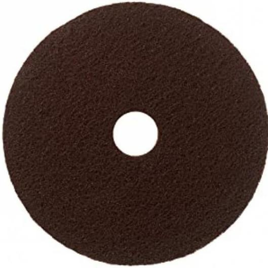
Disque marron spécial décapage des thermoplastiques, une méthode **économique** et **écologique**. Idéal pour le décapage des sols thermoplastiques **sans décapant ni neutralisant**, pour une utilisation à sec ou peu d'eau (pour éviter la poussière). Utilisable à 140 ou 350 tours minutes avec un rendement de 90 m<sup>2</sup>/h.
